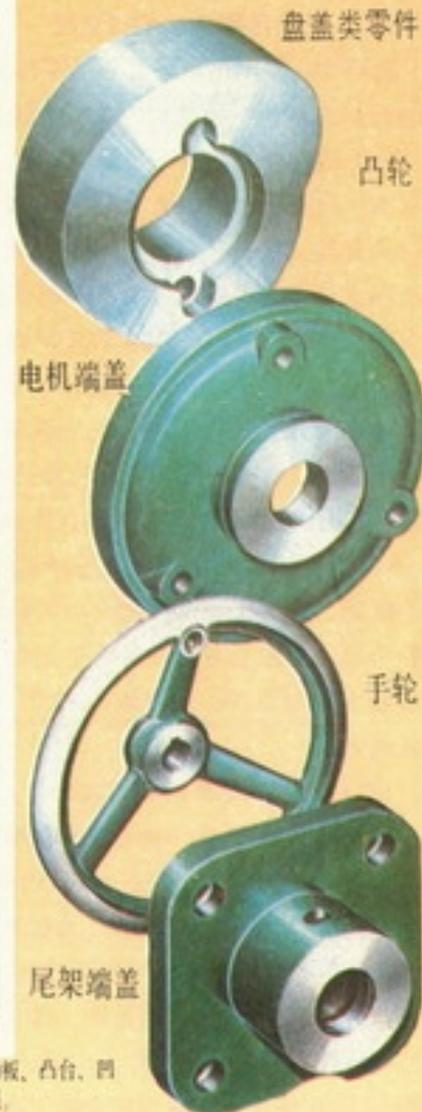
机器上的齿轮、链轮、手轮、凸轮及各种端盖、压盖、法兰盘等，均属盘盖类零件。这类零件上常具有轴孔、键槽、轮辐、辐板、肋板、凸台、凹坑等结构。盘盖类零件的主体多由回转体构成，较多的工序是在车床上进行，因此画图时一般按加工位置将轴线水平放置，以便看图对照。
